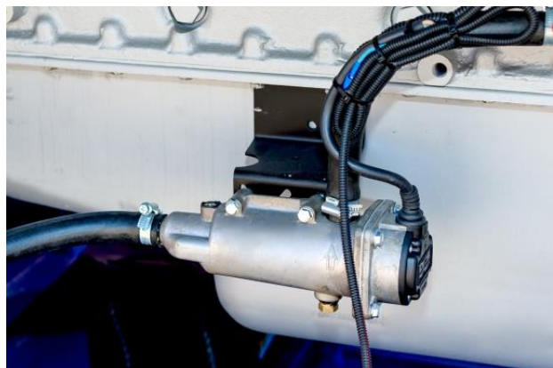
Электрический подогреватель охлаждающей жидкости
