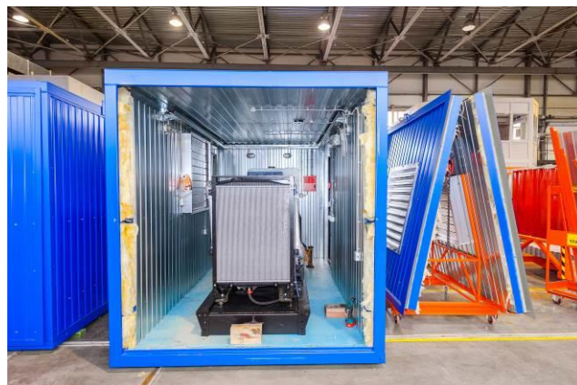
Быстросъёмная торцевая стена для удобства монтажа / демонтажа оборудования, ремонта ДЭС
